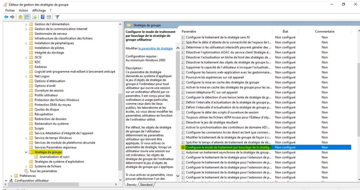
Dans la fenêtre "Configurer le mode de traitement par bouclage de la stratégie de groupe utilisateur", sélectionner "Activé" et choisir le Mode "Remplacer" (pour pouvoir appliquer des GPO utilisateur sur un ordinateur)
